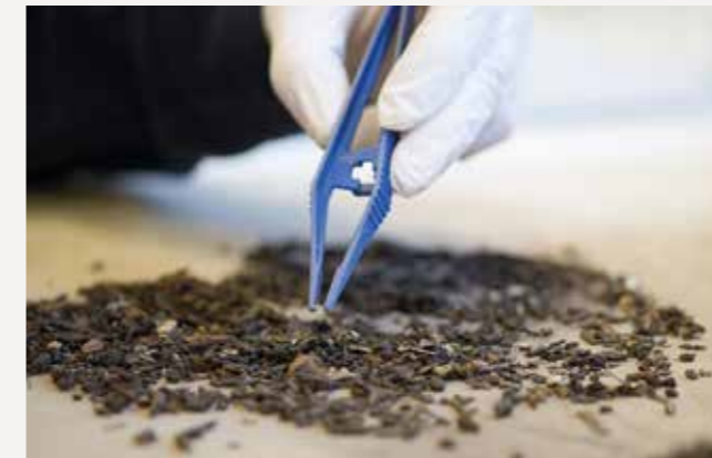
Manuelle Auslese der Fremdstoffe aus einer getrockneten Kompostprobe und Bestimmung der Flächensumme
