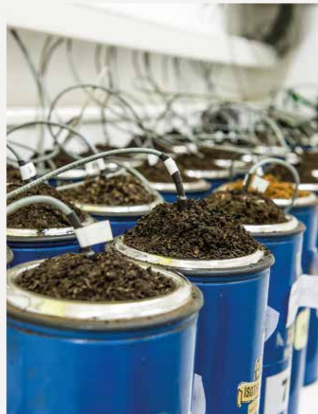
Selbsterhitzungstest von Kompost im Dewar-Gefäß
