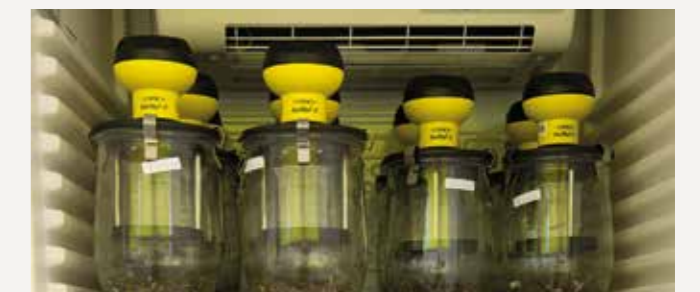
Bestimmung der Atmungsaktivität (AT4) im Klimaschrank
